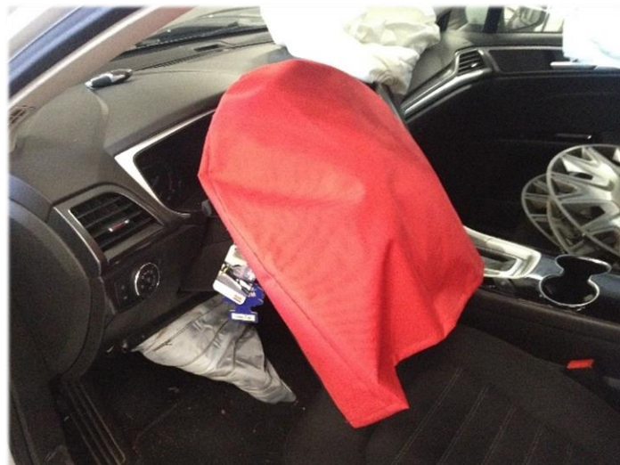
Involucro di messa in sicurezza del volante Fonte immagine: Auto-Soccorso Svizzera
